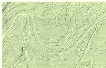
Laserscan (mit/ohne Bewuchs) Donau bei Linz u.a. Grundlage für das digitale Geländemodell
